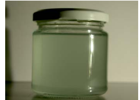
Hauptlauge mit permanenter Laugenfiltration filtriert
